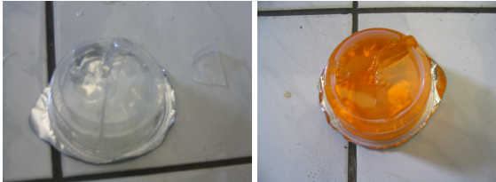
Gambar 13. Pecahnya Jelly Cup Pada Drop Test
